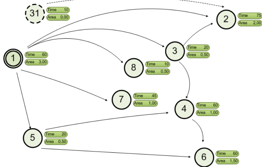
Figura 3: Grafo de precedencias TSALBP con las primeras 8 tareas de una línea de montaje real. Los arcos entre nodos representan las relaciones de precedencia de las tareas mientras que el tiempo y área de las tareas se muestran junto a los nodos del grafo.
