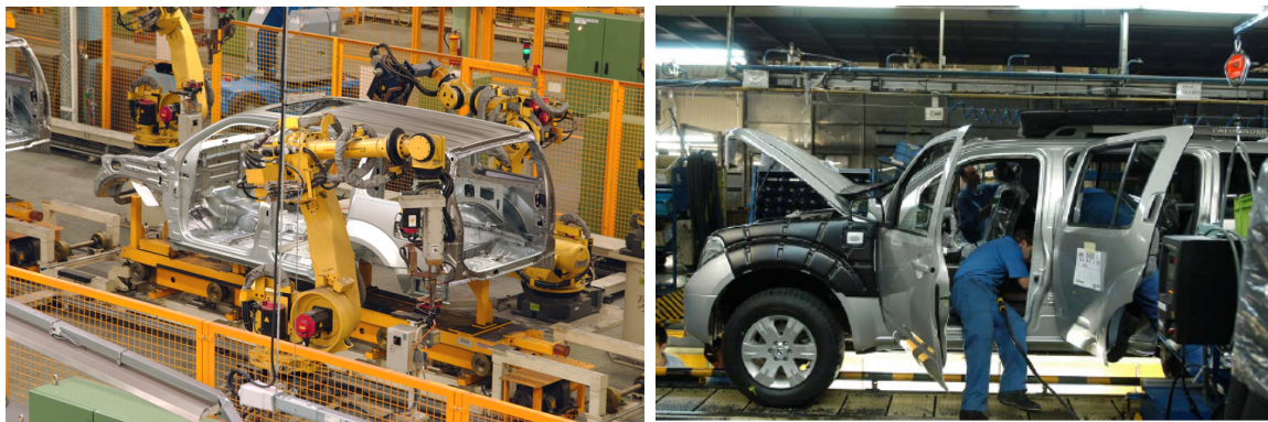
Figura 1: Fotografías de las líneas de montaje de carrocería y vestido del Nissan Pathfinder en la fábrica de Nissan en Barcelona.
